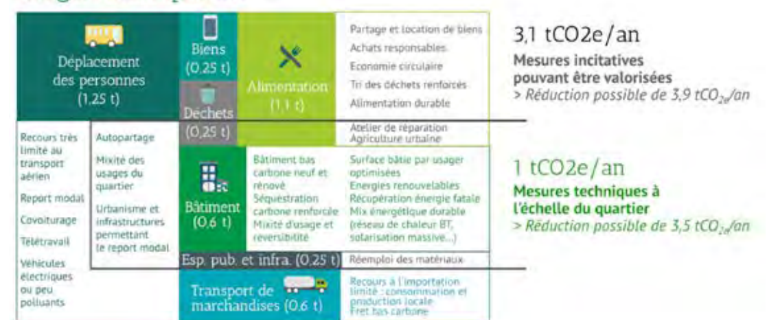
Estimation des réductions d'empreinte carbone réalisables à l'échelle du quartier - Source : BBKA
